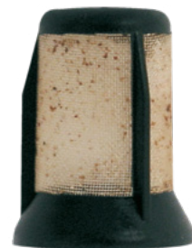
Prefiltro della pompa E3T – intasato dalla ruggine
